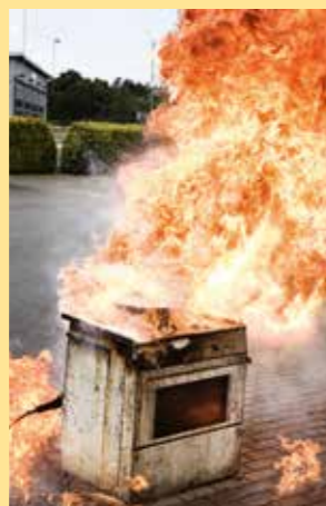
Bilden till vänster visar vad som händer när man försöker släcka en kastrull med överhettad olja med vatten. Använd i stället locket för att kväva lågorna, eller täck över med exempelvis en brandfilt.
