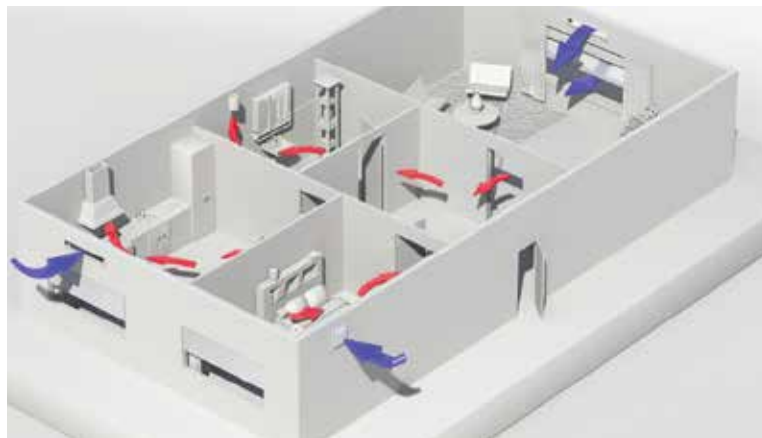
Så här ser flödet av luft ut i en bostad. Kall luft kommer in genom ventiler och fönster. Den värms sedan upp och cirkulerar i rummen.
